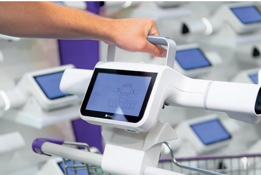
Bild links: Der „Snap Cart“ wird wie ein Handschanner vor der Shopping-Tour auf eine Halterung am Einkaufswagen aufgesteckt Bild rechts: Das Clip-on-System von Shopic ist mit einer integrierten KI-Kamera ausgestattet
